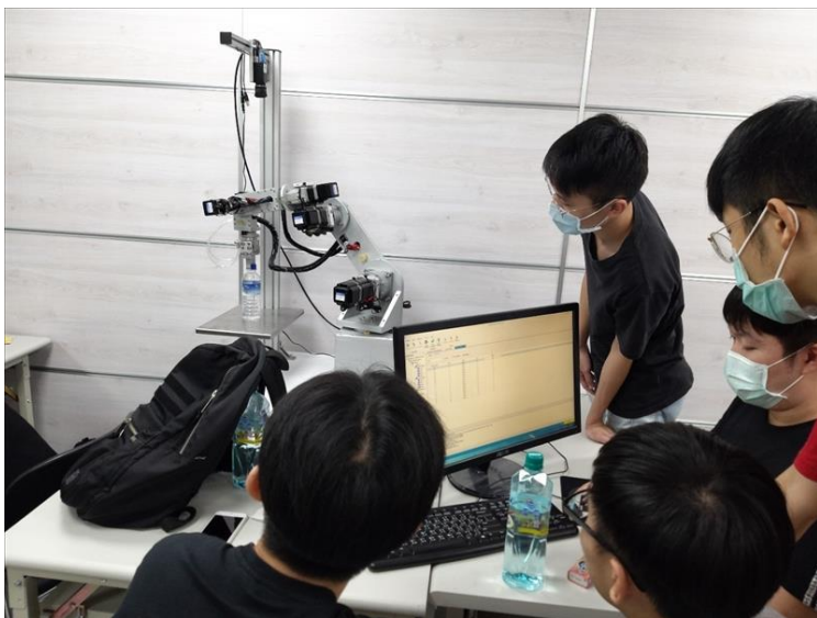
學生透過機械手臂完成物件取放任務
